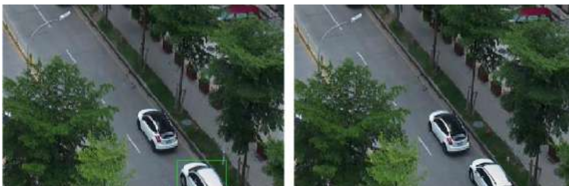
Рис. 4.9. В области ROI изображение более четкое, чем в остальных частях кадра
