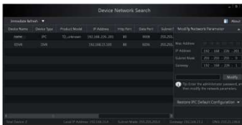
Рис. 2.1. Поиск IP-камеры с помощью утилиты IP-Tool
