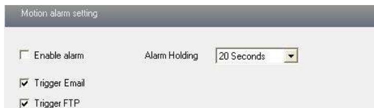
Рис. 4.11. Настройка действий по детектору движения
